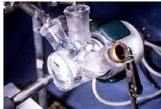
Immagine di un fotoelettrodo per separazione di acqua in  $H_2$  e  $O_2$
