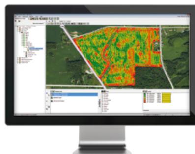
Figura 2: Esempio di sistema GIS utilizzato in agricoltura di precisione per riportare la distribuzione della resa nel campo (Fonte: Trimble, [www.trimble.com/agriculture](http://www.trimble.com/agriculture))
