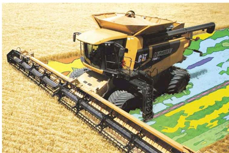
Figura 1 – Esempificazione della creazione di mappe di produzione in fase di raccolto (Fonte: Lexion Combine Division, <http://www.claasofamerica.com/product/channel/lexion-780-730>). Le mappe sono create utilizzando le misure ottenute da appositi sensori collocati a bordo della macchina in grado di valutare il flusso massico di granella raccolta.
