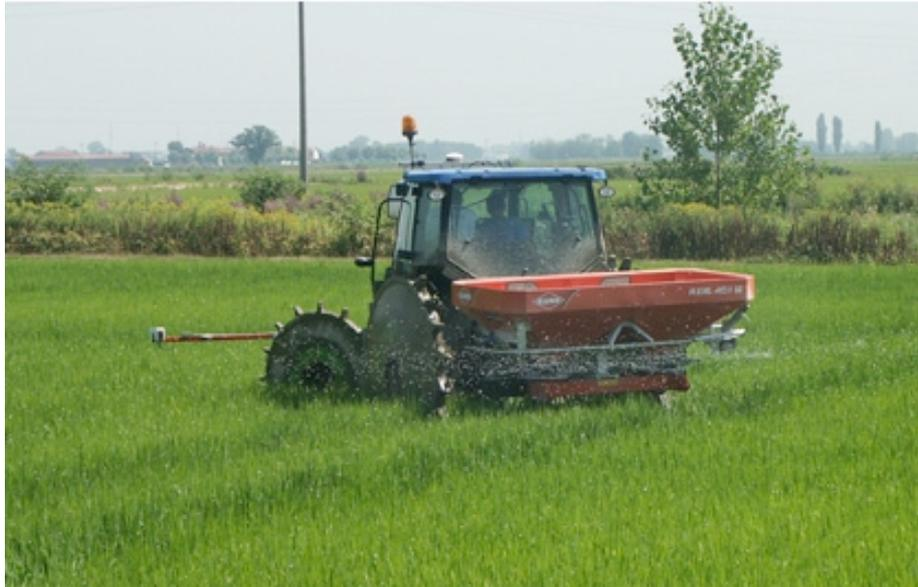
Figura 5: Concimazione a dose variabile (Modello Axis 40 W di Kuhn, fonte: [www.kuhn.it](http://www.kuhn.it))
