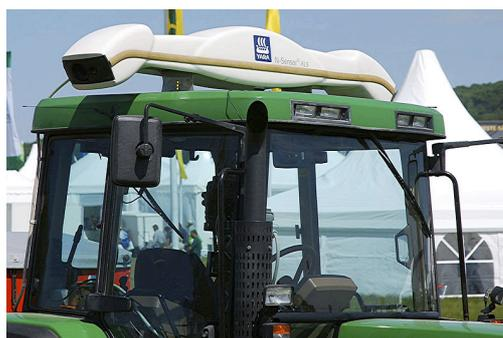
Figura 3 - Esempio: sensore *N-Sensor Active Light Source (ALS)*, basato su sorgente di luce Xenon, prodotto da Yara (Fonte Yara, <http://www.yara.com>) e installato su una trattoria John Deere.
