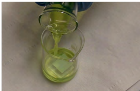
Figura 9: Immersione dell'elettrodo nel colorante
